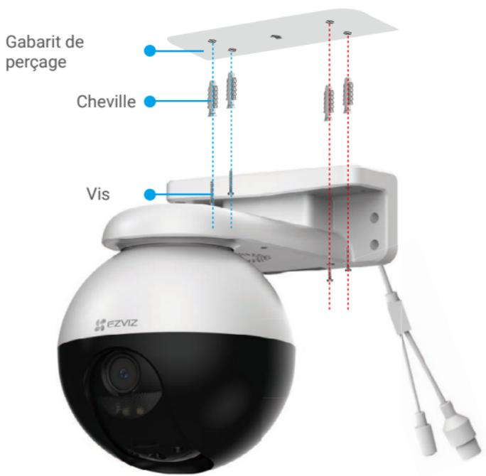
Fig. 1 Montage au plafond
